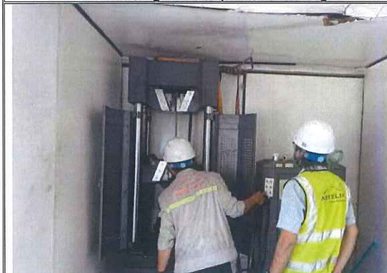
Công tác thí nghiệm kéo, uốn mẫu thép kiểm tra chất lượng cốt thép hiện trường
